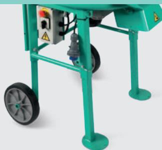
Altezza di carico/scarico regolabile. Grazie alle gambe estensibili è possibile regolare l'altezza di carico più comoda per il riempimento della tramoggia, compatibile con l'altezza del recipiente dove si scarica il materiale:
