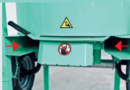
Guide per carrello elevatore. Facilitano la movimentazione nei depositi ed in cantiere.
