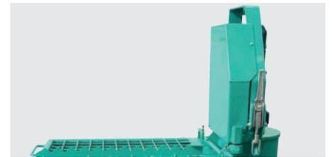
Deviatore di flusso aria di raffreddamento del motore mescolatore, per evitare il diffondersi delle polveri nell'ambiente di lavoro durante il caricamento a sacco.
