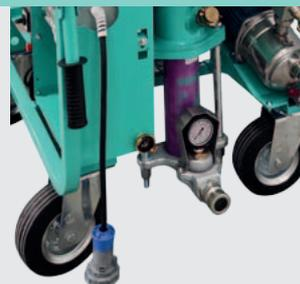
Flangia di mandata materiale in ghisa con misuratore di pressione. Connessione diretta per tubo DN35 F. Permette di estendere le tubazioni fino a 30 m con il minimo incremento delle pressioni di lavoro. La riduzione per applicare il tubo DN 25 è inclusa nell'equipaggiamento di serie.
