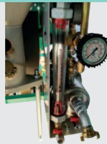
Impianto idraulico in ottone anti-ossidazione. Disposizione dei componenti studiata per migliorare il drenaggio dell'acqua nei periodi invernali. Elettropompa autoadescente maggiorata INGX3, capace di 4,5 bar di pressione e portata fino a 2500 l/h, con calotta in acciaio inox e girante in ottone.
