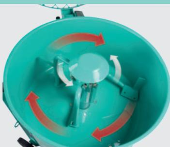
Il sistema di inversione del senso di rotazione delle pale, attivabile attraverso il selettore posto sul quadro di comando, permette di disintegrare eventuali grumi e di riprendere la mescolazione normale senza interventi manuali diretti.
