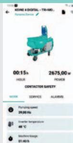
Interconnessione IoT via Bluetooth con lo smartphone dell'utilizzatore tramite l'app **IMER CONNECT** scaricabile gratuitamente da Google Play o App Store. L'interconnessione permette di monitorare lo stato della macchina in ogni momento, mantenere sotto controllo le ore di funzionamento e molti altri parametri, utili alla ricerca di eventuali anomalie di funzionamento, condivisibili via SMS con il Servizio Assistenza IMER.
