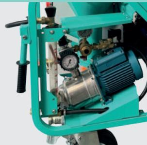
Disposizione dei componenti studiata per migliorare il drenaggio dell'acqua nei periodi invernali. Elettropompa autoadescante di generose dimensioni, capace di 4,5 bar di pressione, con calotta in acciaio inox e girante in ottone.
