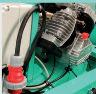
Compressore a pistoni C400 (400V/50Hz - 2,2 kW), integrato e protetto sotto la cappotta. Escludibile elettricamente tramite pulsante On/Off, quando non necessario.
