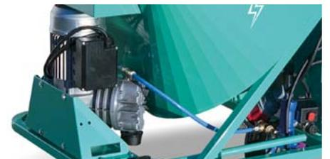
Compressore a membrane fissato a bordo macchina.
