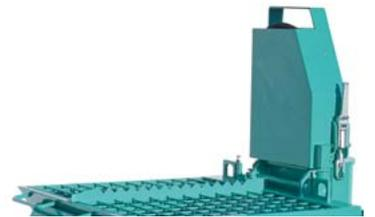
Deviatore di flusso aria di raffreddamento del motore mescolatore, per evitare il diffondersi delle polveri nell'ambiente di lavoro durante il caricamento a sacco.
