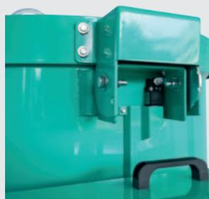
Un dispositivo elettrico di sicurezza blocca la rotazione delle pale di mescolamento in modo automatico quando viene alzata la griglia I-DUST. Il dispositivo agisce nella cerniera di apertura ed è posizionato in un punto protetto da urti e dallo sporco.
