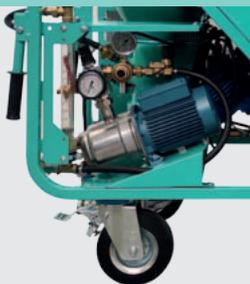
Disposizione dei componenti studiata per migliorare il drenaggio dell'acqua nei periodi invernali. Elettropompa autoadescante di generose dimensioni, capace di 4,5 bar di pressione, con calotta in acciaio inox e girante in ottone.
