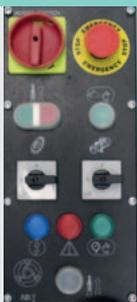
Quadro di comando semplice e funzionale come il suo particolare impianto elettrico, progettato per ridurre le componenti attive ed ottimizzare le dimensioni delle parti più soggette ad usura, incrementando notevolmente l'affidabilità. Dotato di invertitore di fase manuale con segnalazioni luminose di fase corretta, allarme sovraccarico, pressione acqua ottimale e stato di comando remoto stand-by.
